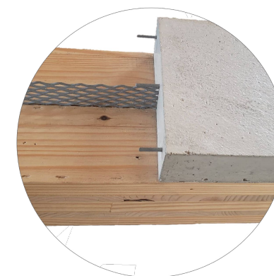
detalhe da laje mista de CLT com 5 camadas e concreto
